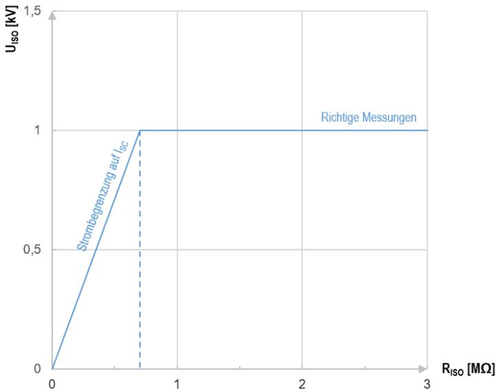
Die momentane Prüfspannung U<sub>ISO</sub> als Funktion des gemessenen Isolationswiderstandes R<sub>ISO</sub> (zur Nennspannung) dargestellt
